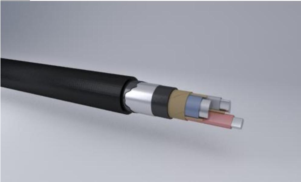
Кабели силовые с алюминиевой жилой, бумажной пропитанной изоляцией, в алюминиевой, с защитным покровом типа Шнг
