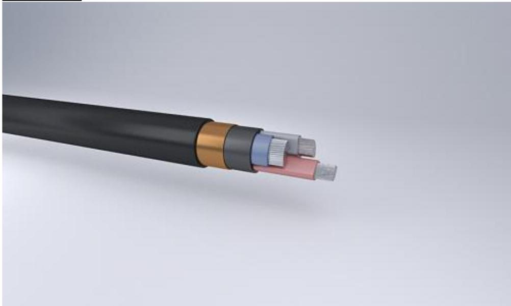
Кабели силовые с алюминиевыми жилами, изоляция из ПВХ пластиката, оболочка из ПВХ пластиката пониженной горючести, без защитного покрова, экранированные
